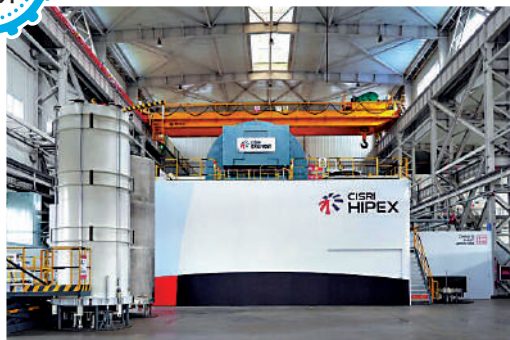
▲中國鋼研的先進裝備HIPEX1850可應用於航空航天級零部件加工。
