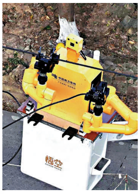
▲全國首台MR遙操作帶電作業機器人「悟空」在戶外作業。網絡圖片
