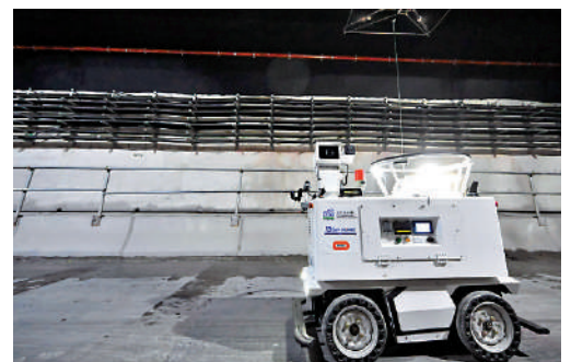
▲地空協同隧道自動檢測系統配備超高清相機，自動檢測拍攝隧道內部結構。
