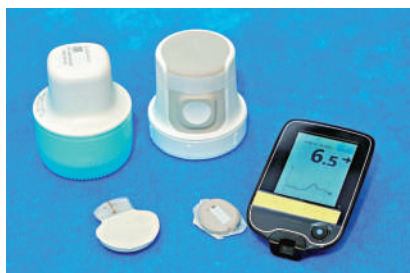
▲植入皮膚的感應器配合傳送器，可24小時監測血糖。
