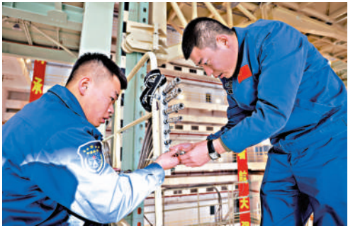
▲11月9日，工作人員在對神二十號的供氣管路進行吹除作業。
