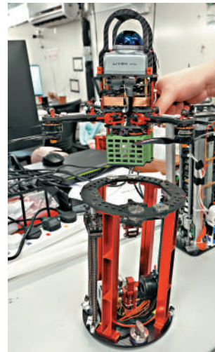
▼港大最新研發的彈射無人機系統，該款無人機通過彈射器可以馬上彈射，只需數秒就可以飛到空中快速部署。
