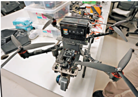
▲Super LiDAR配備旋轉激光雷達，實現全方位掃描，結合AI算法，可以實現低空飛行器在無GNSS情況下定位、在線檢測、規避能力。
