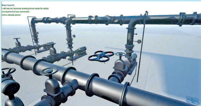
▲為配合「數碼分身」拓展不同類型應用場景，鄭展鵬團隊同步研發室內無人機系統，已成功應用於管道檢測等狹窄空間。
