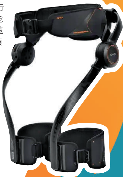
◀消防員穿戴的外骨骼通過機械結構將背負重量有效分散至腿部和地面，減少對肩、腰、膝關節的壓力。
