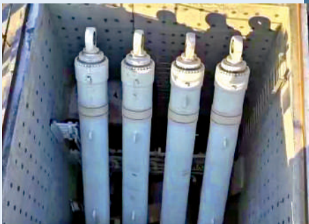
▲正在建設中的海上液體火箭發射回收試驗平台，液壓基坑裏的4個液壓起豎油缸能幫助火箭調整發射姿態。
