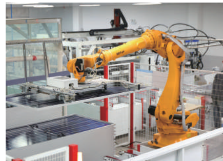
▲在江蘇淮安新源太陽能科技公司生產車間內，工業機器人生產光伏組件。
