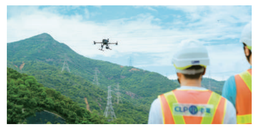
▲中電運用無人機等先進技術加強巡查供電設施的效率。
