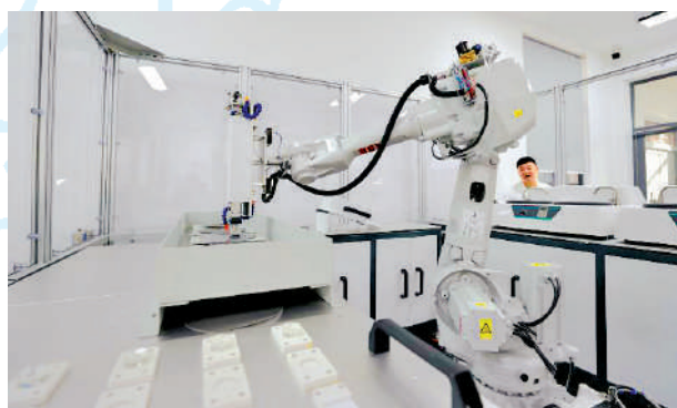
▲全球首個古陶瓷基因庫標本機器人柔性製樣系統。
