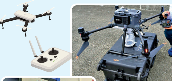
▲「智鷹勇」可低飛至接近水面採集水樣本，交由實驗室分析水塘水質。
