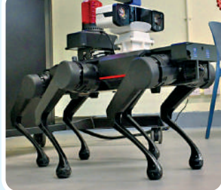
▲「智衛犬」協助巡邏水務署設施，透過氣體探測器等裝置，監察是否有異常情況。
