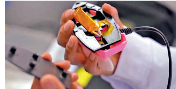
▲拆解「拼豆」玩具配套的小熨斗可見，發熱體沒有控溫裝置。視頻截圖
