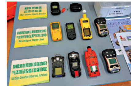
▲勞工處配備不同種類的氣體測試設備，遇有害氣體時會發出警響。
