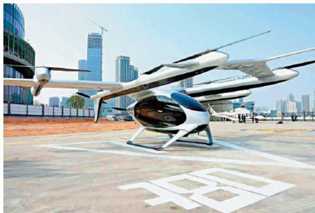
▲eVTOL「盛世龍」為複合翼構型，最多可搭載5人。
