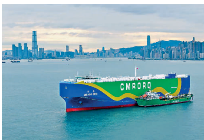
▲全球第一艘甲醇雙燃料動力滾裝船並在香港註冊的「港榮」輪，三月初在錨地接受全港首次綠醇加注。
