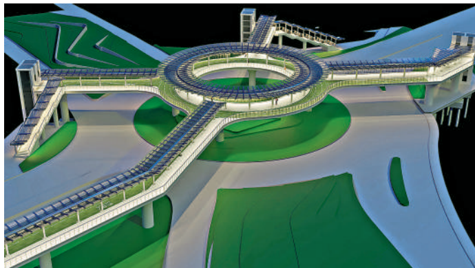
▲龍躍頭交匯處的單車徑暨行人天橋採用S960國產超高強鋼建造，是全球首座使用該級別鋼材的行人天橋。
