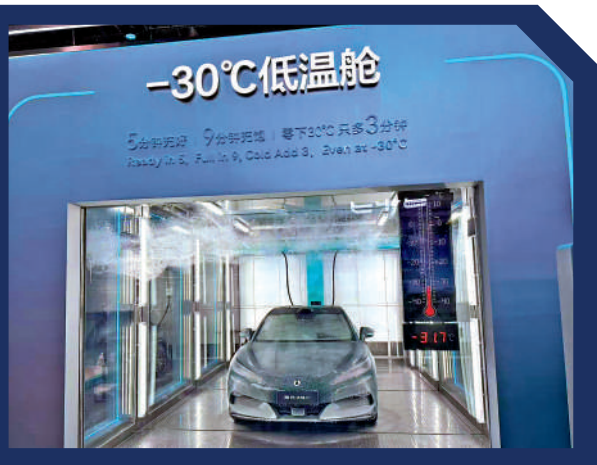
▲比亞迪在-30度的低溫艙內現場真實測試閃充技術。
