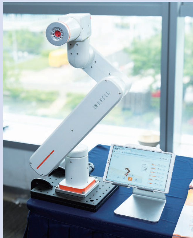
「毫米級」輕量化力控機械臂：突破重量限制，單臂重量僅約0.5公斤，卻能達到毫米級操作精確度，主打高靈活性及高精度操作，可靈活安裝於不同操作平台。
