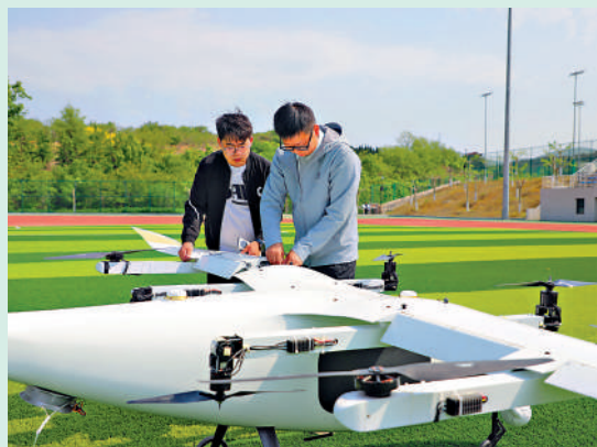
▲科研人員在調試第二代傾轉旋翼氫電混動無人機。
