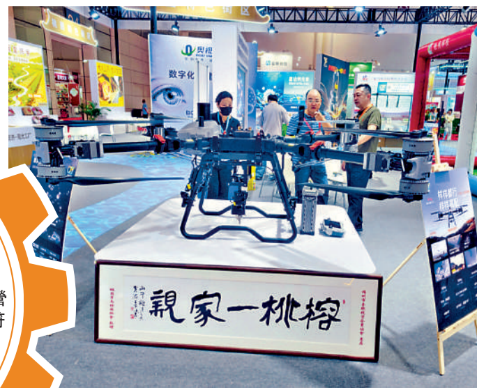
▲在福州舉行的海交會桃園交流區，一架無人機吸引兩岸嘉賓注意。其最大調運重量180公斤，可用於光伏材運輸、救援物資運輸等。大公報記者蘇榕蓉攝
