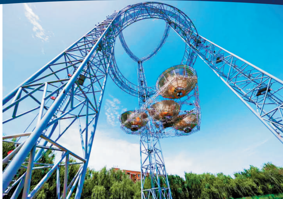
▲位於西安電子科技大學南校區的「逐日工程」空間太陽能電站地面驗證系統。受訪者供圖
