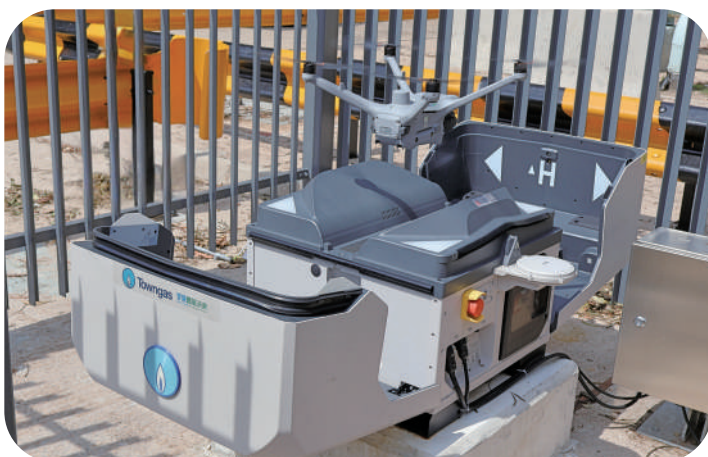
▲管道巡檢無人機在空中沿管道路線監測，技術人員可即時透過數據了解管道的情况。
