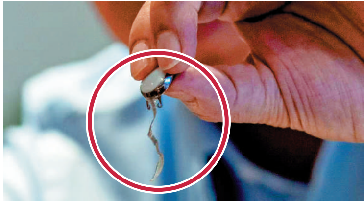
▲中南大學湘雅醫院試驗使用的IMIE智能視網膜系統核心植入器件，可為失明患者重建人工視覺信息傳導通路。
