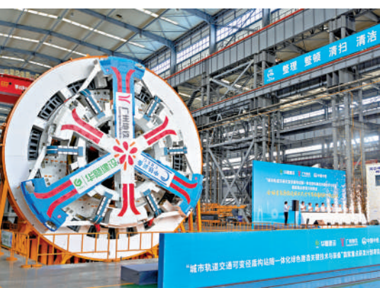
▲大灣區軌道工程項目合作，可望帶動相關設備供應「走出去」。圖為廣州地鐵參與研製的原位可變徑盾構機。 中新社
