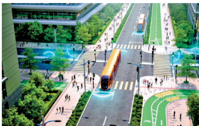
▲洪水橋／廈村智慧綠色集體運輸系統不設實體軌道，旨在為該區約30萬居住人口及16萬就業人口提供高效、低碳的交通接駁服務。
