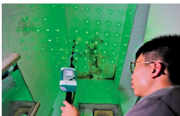
▲滲水辦可利用各種先進儀器探測天花板的濕度，確定單位是否有滲水，再追蹤及分析滲水軌跡。大公報記者蔡文豪攝
