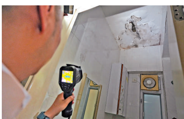
▲滲水辦可利用各種先進儀器探測天花板的濕度，確定單位是否有滲水，再追蹤及分析滲水軌跡。大公報記者蔡文豪攝
