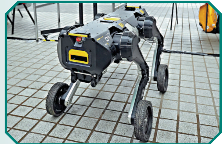
▲全球首款模組化機器人，具備自動拼接與分拆功能，應用於清潔、巡邏及工業場景。
