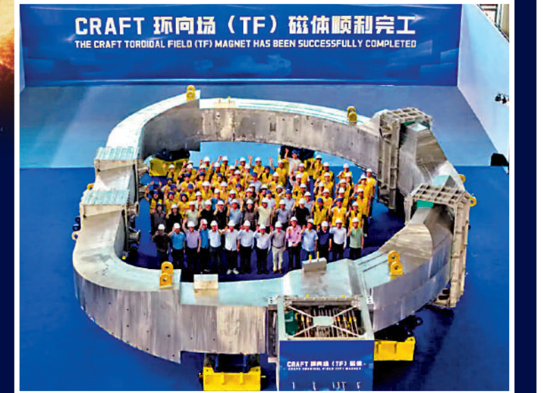
▲我國自主研製的環向場磁體是世界上體積最大的聚變堆超導磁體，長21米、寬12米、高3.3米，總重量達582噸。 央視網
