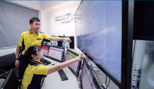
▲港鐵「機電系統整合測試中心」引入「虛擬車站」概念，提早於車站外進行機電系統整合測試。東鐵綫古洞站平頂之際，約六成機電整合測試已完成。
