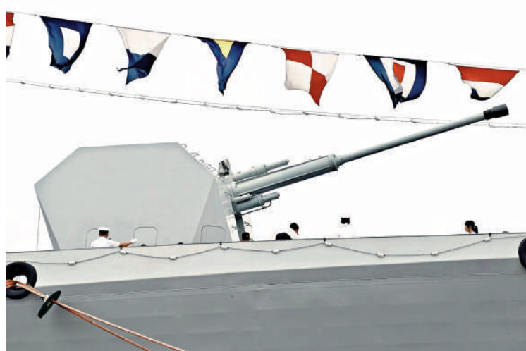
▲南寧艦有一門主炮為130毫米單管艦炮，特點是射程遠、射速高。
