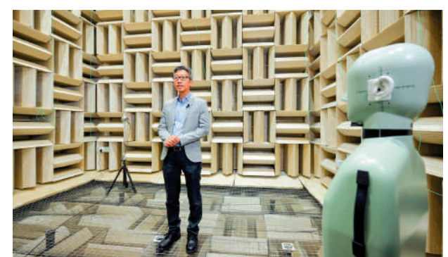
▲自由場聲學消聲室內牆的吸音材料能大幅減少回音，有助高精度聲學儀器進行準確校正。
