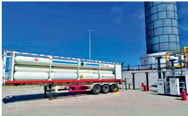
▲今年4月，由中海石油氣電集團技術研發中心自主研製的高純氦氣提取裝置順利完成試產，並成功實現裝車外運，該裝置產出的氦氣產品純度穩定達到99.999%以上。
