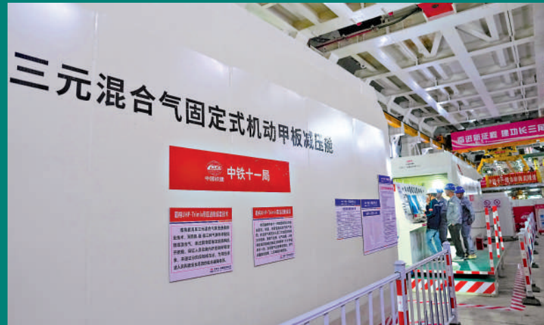
▲5月8日，我國首套「三元混合氣」盾構帶壓作業裝備正式應用於世界最長海底高鐵路——甬舟鐵路金塘海底隧道建設，這套可科學配比氦氣、氮氣、氧氣三種混合氣體的新型國產裝備由中鐵十一局自主研發。
