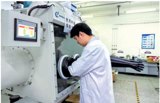
▲單晶鑽石籽晶培育過程經過精密計算得出。圖為工作人員用惰性氣體手套箱培育金剛石。 大公報記者于海江攝
