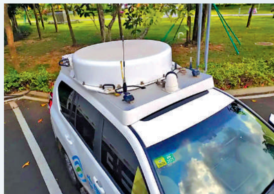
▲車載衛星基站等可搭建臨時通信節點，讓救災更高效順暢。
