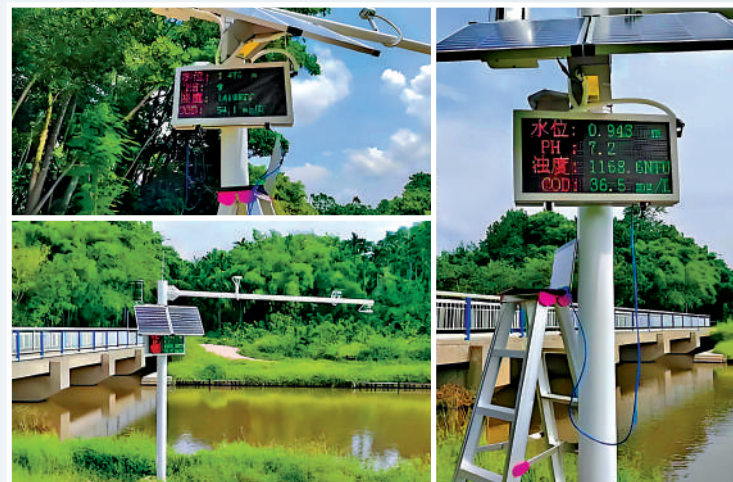
▲智能水位監測儀器能夠24小時自動上傳河流湖泊的水位數據。
