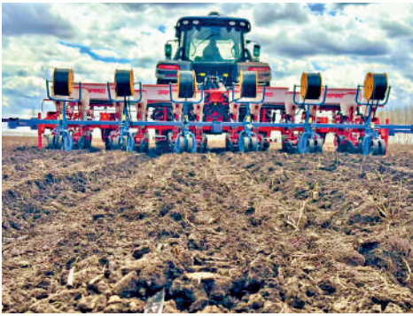
▲現代農機可在翻地的輸送管網鋪設時間，將水肥一體化滴灌技術真正落地到田間頭。
