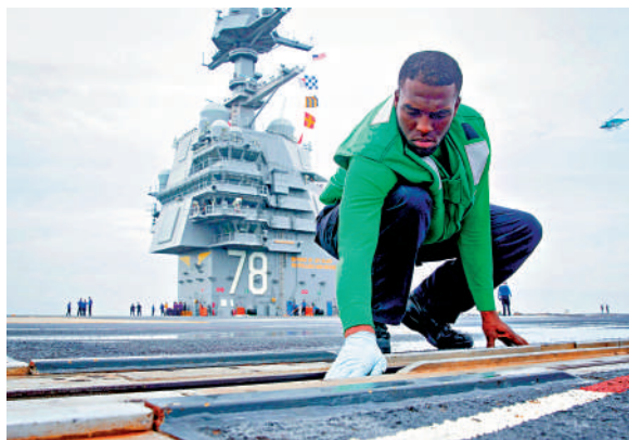
▲美軍士兵在「福特」號航母上為電磁彈射系統進行潤滑作業。
