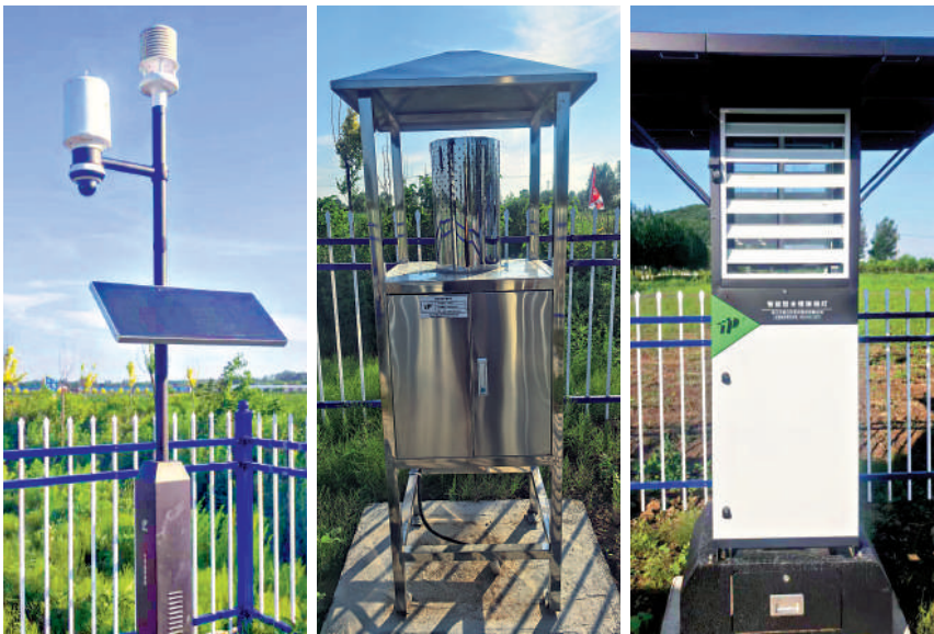
▲「中國智慧農業第一鎮」的智能型蟲情測報燈（右）、固定式孢子捕捉儀（中）和氣象監測系統。大公報記者于海江攝
