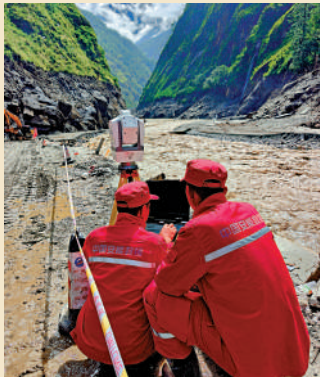
▲8月30日，中國安能專業救援人員利用激光AI監測儀，動態監測滑坡、落石等風險。新華社
