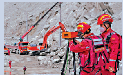
▲9月3日，吉隆口岸受災核心區救援投入邊坡雷達，監測作業現場危岩體形變。
