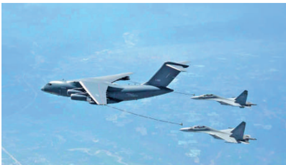
▲空中加油被稱為「厘米級飛行」。圖為運油-20A加油機為兩架殲-16戰鬥機空中加油。 資料圖片
