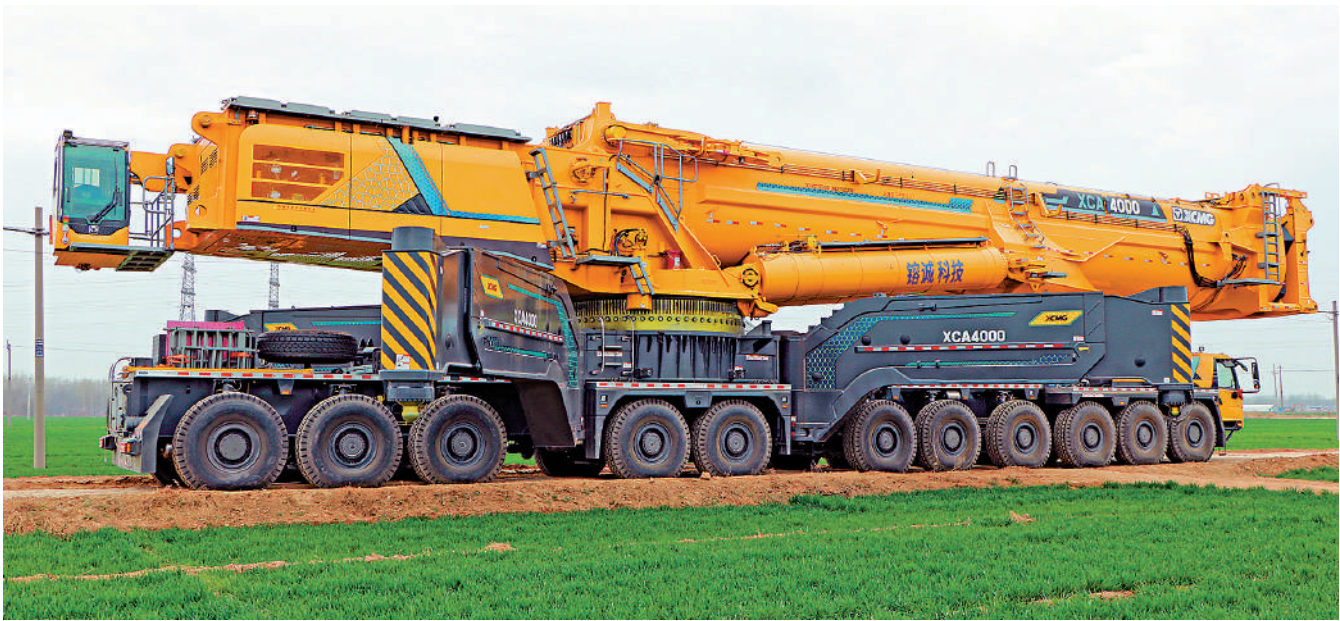
▲中國自主研製的全球首款額定最大起重能力達4000噸的「巨無霸」XCA4000輪式起重機。
