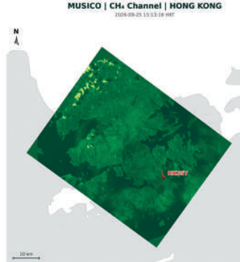
▲「天韻相機」甲烷探測儀拍攝的香港影像，顏色變化反映儀器接收到的不同輻射信號（Radiance）強度。科大圖片
