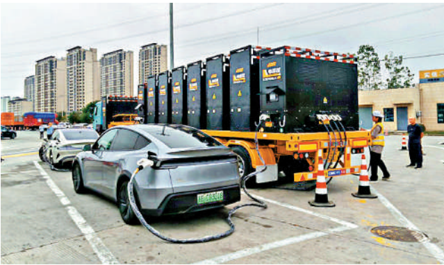
▲搭載大容量儲能設備的「重卡移動充電站」出現在安徽等省市部分服務區。網絡圖片
