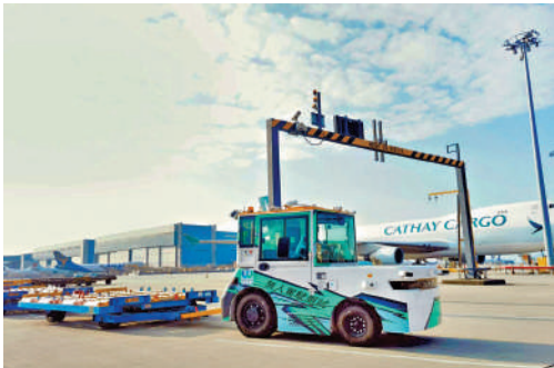
▲西井科技Q-Tractor無人駕駛新能源牽引車在香港國際機場。受訪者供圖
