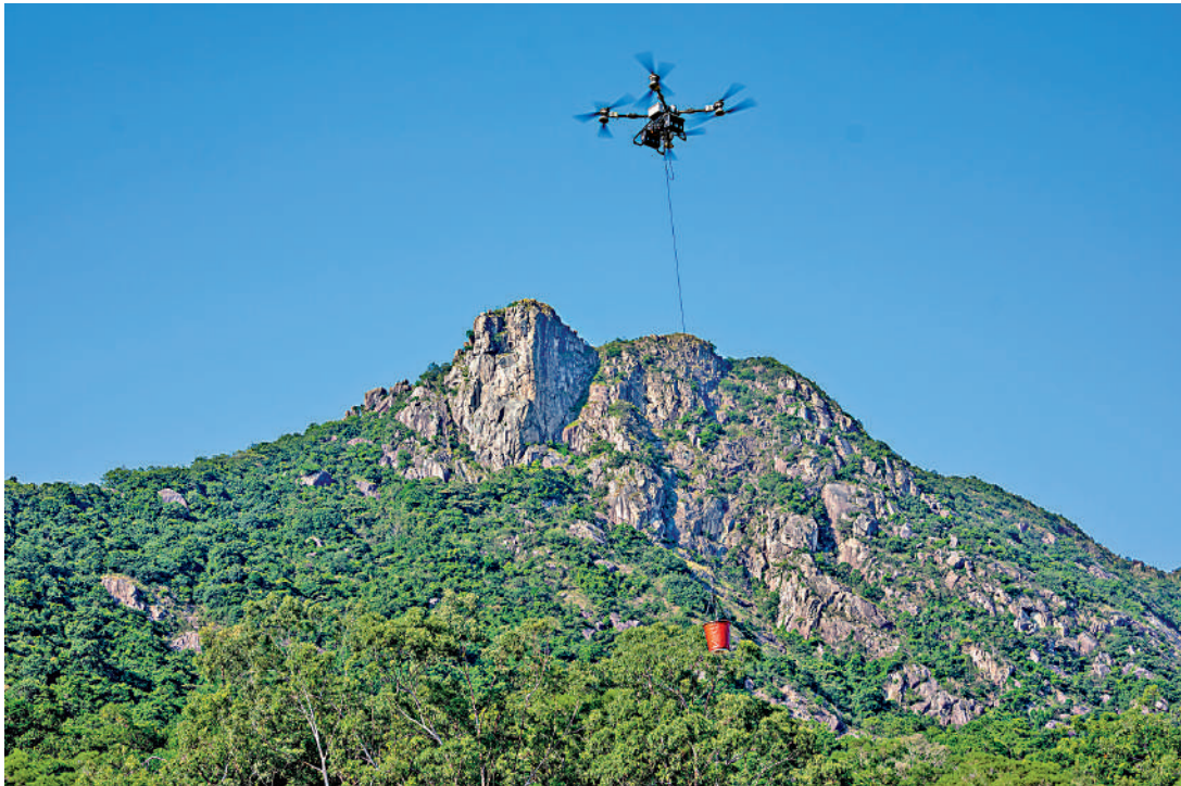
►配備自動水彈投放系統的大型無人機。
