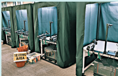
▲實驗室內搭建多個標準機械臂測試平台，用於批量接入大模型，來做相關測評。 港大供圖
