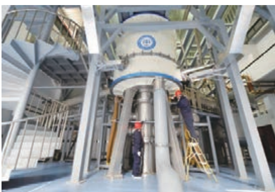
■合肥穩態強磁場實驗裝置的混合磁體。
