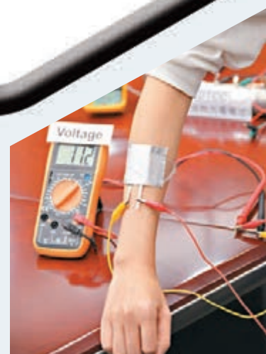
DTCC貼身體上可用體溫為智能科技產品供電作醫療監測。
